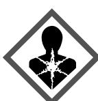
Das Symbol kann sich auf dem Kompressor befinden. Es bezieht sich auf das Öl im Kompressor und weist auf folgende Gefahr hin: **Kann bei Verschlucken und Eindringen in die Atemwege tödlich sein.** Dieser Hinweis ist nur für das Recycling bedeutsam. Im Normalbetrieb besteht keine Gefahr.
